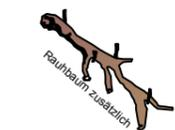
Rauhbaum - gesichert durch Eichenpfähle - als Zusatzmaßnahme: Böschung Ost
