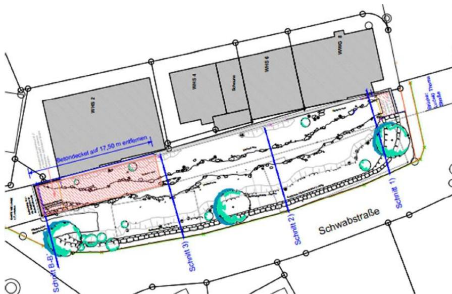
Innerhalb des Geltungsbereichs geht ein Retentionsvolumen von  $54,72 \text{ m}^3$  verloren. Mit der genannten Renaturierungsmaßnahme wird ein Retentionsvolumen von  $350 \text{ m}^3$  neu geschaffen und der Retentionsraumverlust somit umfang-, funktions- und zeitgleich ausgeglichen. Eine detaillierte Berechnung enthält die Stellungnahme nach § 78 WHG (MAUTHE 2021).
