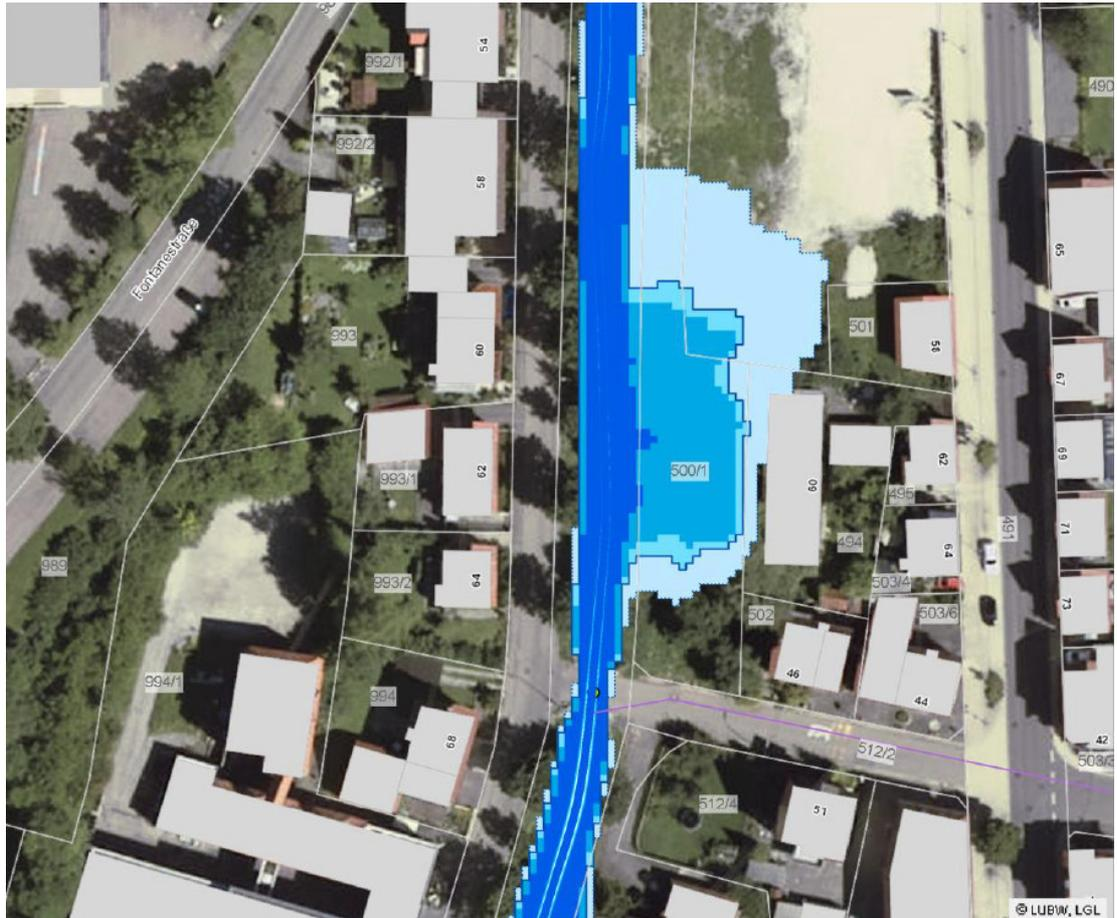
Die Überflutungsfläche eines HQ<sub>100</sub> ist im Ist-Zustand aus der Bearbeitung der Hochwassergefahrenkarte in Anlage 1 dargestellt.
