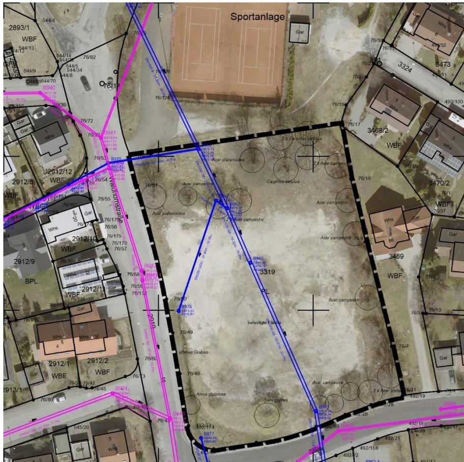
Abbildung 4 - Lageplan Bestand Luftbild mit Bäumen und Niederschlagswasserkanal (blau) und Schmutzwasserkanal (magenta)
