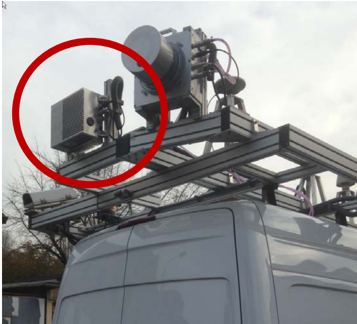
Abb.: CPS-Laserscanner auf mobilem Messfahrzeug I.R.I.S 5
