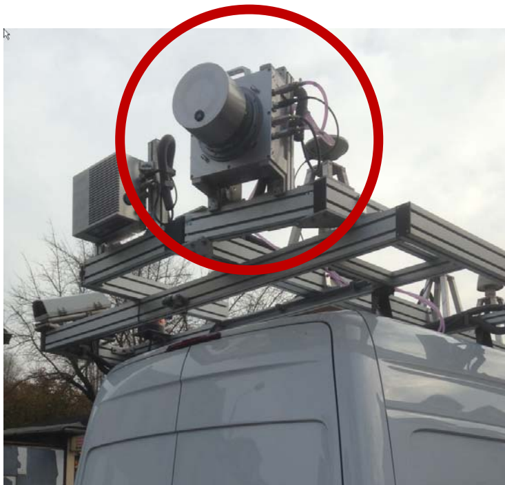
Abb.: CPS-Laserscanner auf mobilem Messfahrzeug I.R.I.S 5
